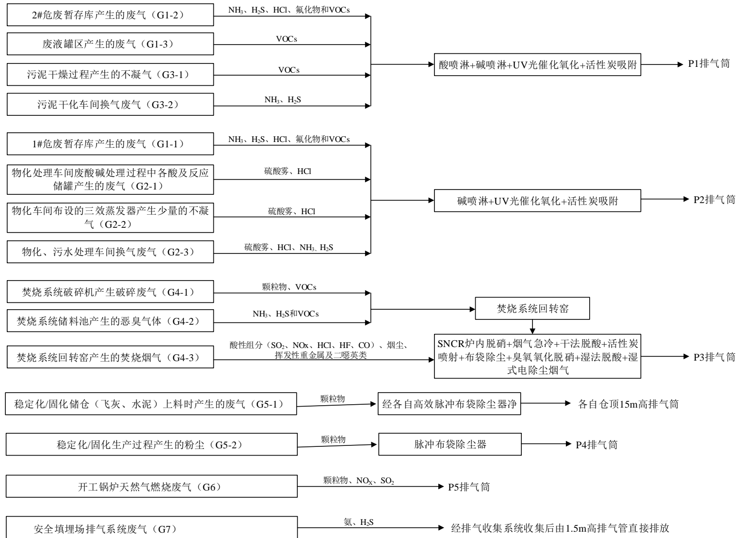
图 2-7-1 在建工程废气治理及排放措施
